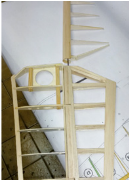
Das Leitwerk entsteht in leichter Rippen-Bauweise. Beachtenswert sind die Hohlkehlscharniere
