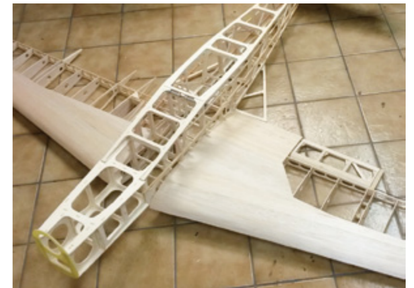
Noch ist der Rumpf nur ein eckiger Kasten. Erst durch den Rumpfrücken wird daraus unverkennbar eine Zlin 526
