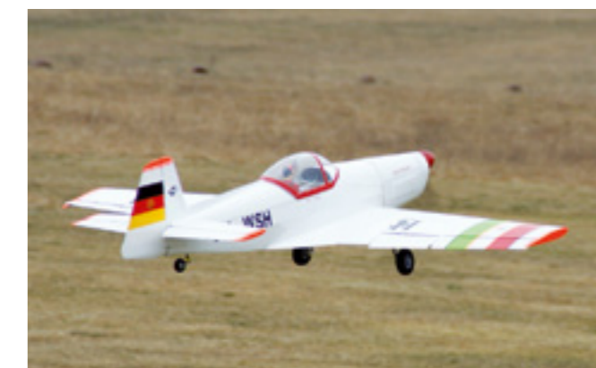
Mit 380 Watt pro Kilogramm Modellgewicht lässt die Motorleistung keine Wünsche offen
