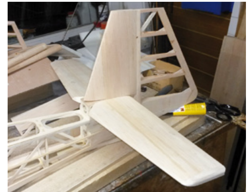
Nach dem Beplanken die erste Anprobe des Leitwerks
