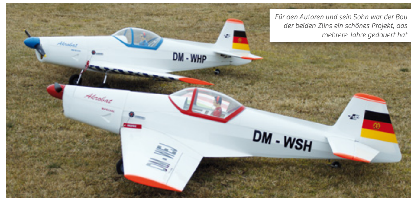
Mit 380 Watt pro Kilogramm Modellgewicht lässt die Motorleistung keine Wünsche offen
