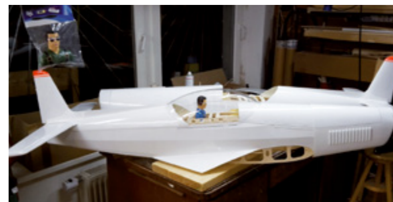
Die Grundfarbe der Testmodelle ist weiß. Das hat den Vorteil, dass die GFK-Teile farblich bereits passen
