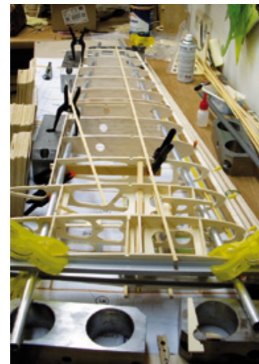
Zwei Alu-Rohre dienen beim Bau als Helling, damit hinterher alles passt
