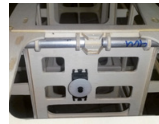
Vorbereitung für die Schleppkupplung – hier wurde von der Anleitung abgewichen
