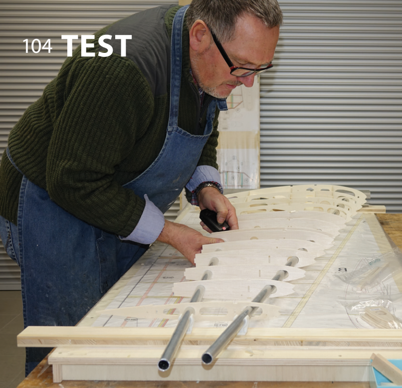
Die Rohr-Helling: Die Rippen der Tragfläche werden auf zwei Alu-Rohre geschoben...
