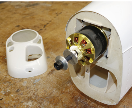
Der Scorpion SII-5535-160 kV passt ideal für die Zlin, er wiegt 975 g.
