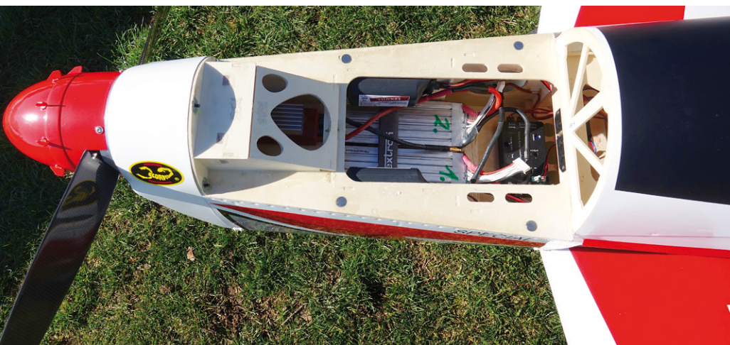
▲ Das Akkufach für die zwei Extron-6s-5.000-mAh-LiPos ist gut zugänglich. Hier ist auch die Empfängerstromversorgung untergebracht.
