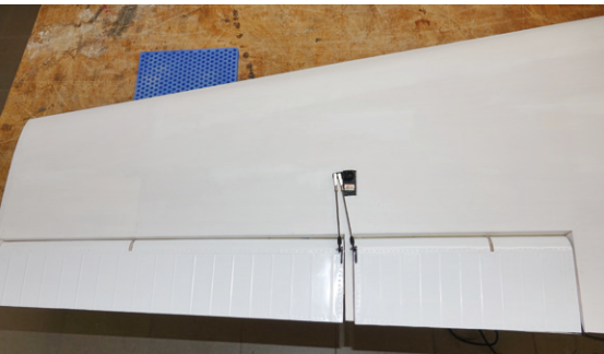
Die Anlenkung des zweiteiligen Querruders erfolgt einzeln – die unterschiedlichen Ausschläge der beiden Klappen können vernachlässigt werden.
