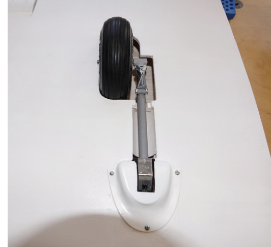
Das Zweibeinfahrwerk wird vorbildgetreu nach hinten eingefahren. Eine Verkleidung deckt die Montageöffnung für die Mechanik ab.
