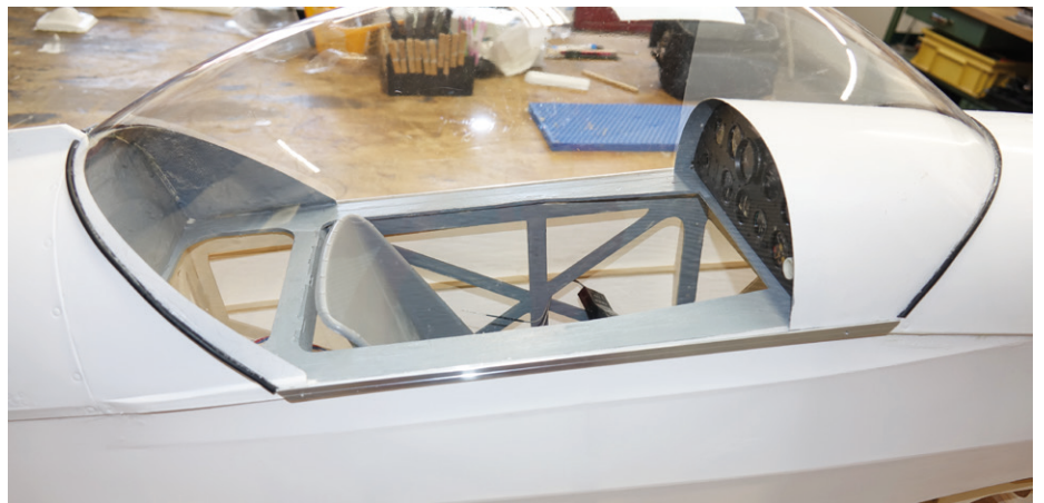
Die Kabinenhaube wird unter Verwendung von U-Gummis und Alu-Schienen montiert.
